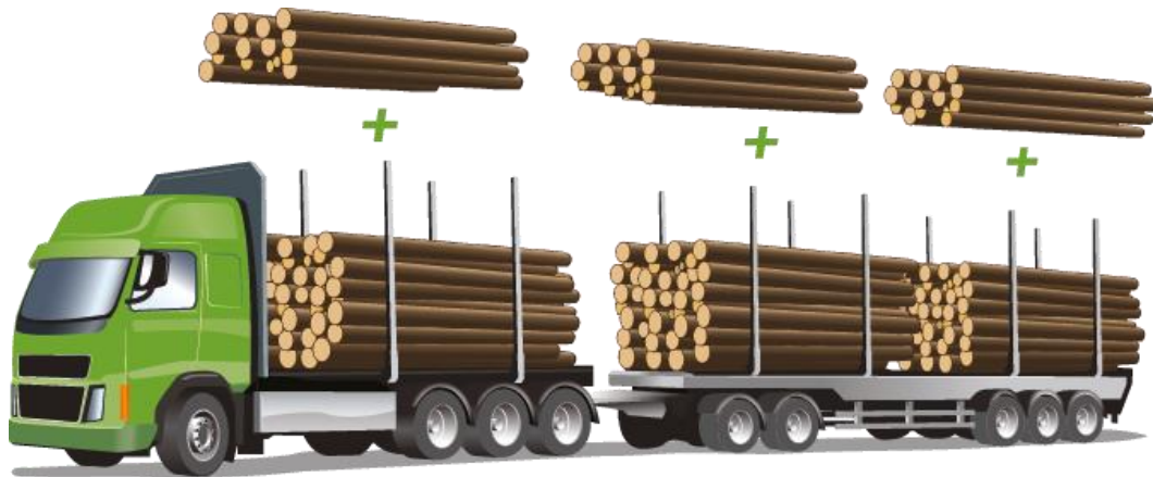
Figur 1. Högre tillåten bruttovikt är det möjligt att med dagens tillåtna axellaster (vikt per hjul) och dagens tillåtna fordonsvikter (d.v.s. max tillåtna vikt för lastbil och släp enskilt) ta mer last. Lasten fördelas på fler hjulaxlar axlar (9 istället för 7) och därmed effektivisera transportererna utan överlast eller ökat slitage på vägen.
